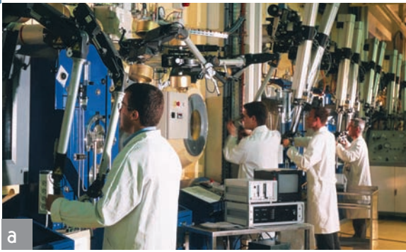
a. Télémanipulateurs dans le laboratoire d'examen et d'essai sur matériaux irradiés.
